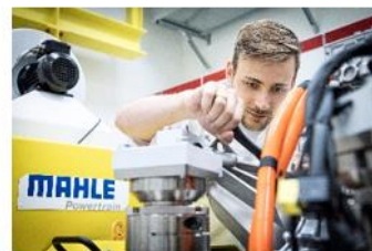
Eingespannt zwischen die zwei Lastmaschinen wird der E-Antrieb unter realen Fahrbedingungen geprüft.
